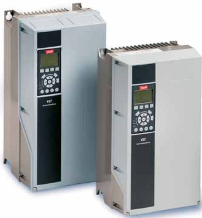
FC 300 en protection IP 55/IP 66. Ici aussi, tous les composants tels que le filtre CEM et les selfs DC sont intégrés. Les câbles entrent dans le boîtier sécurisé par la partie inférieure.
