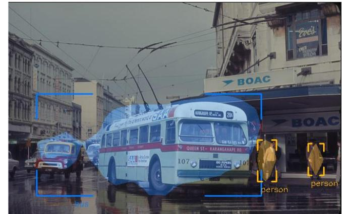
Avancement : Démo de détection de véhicules et piétons sur une plateforme embarquée (Jetson) en temps réel (~10 Hz)
